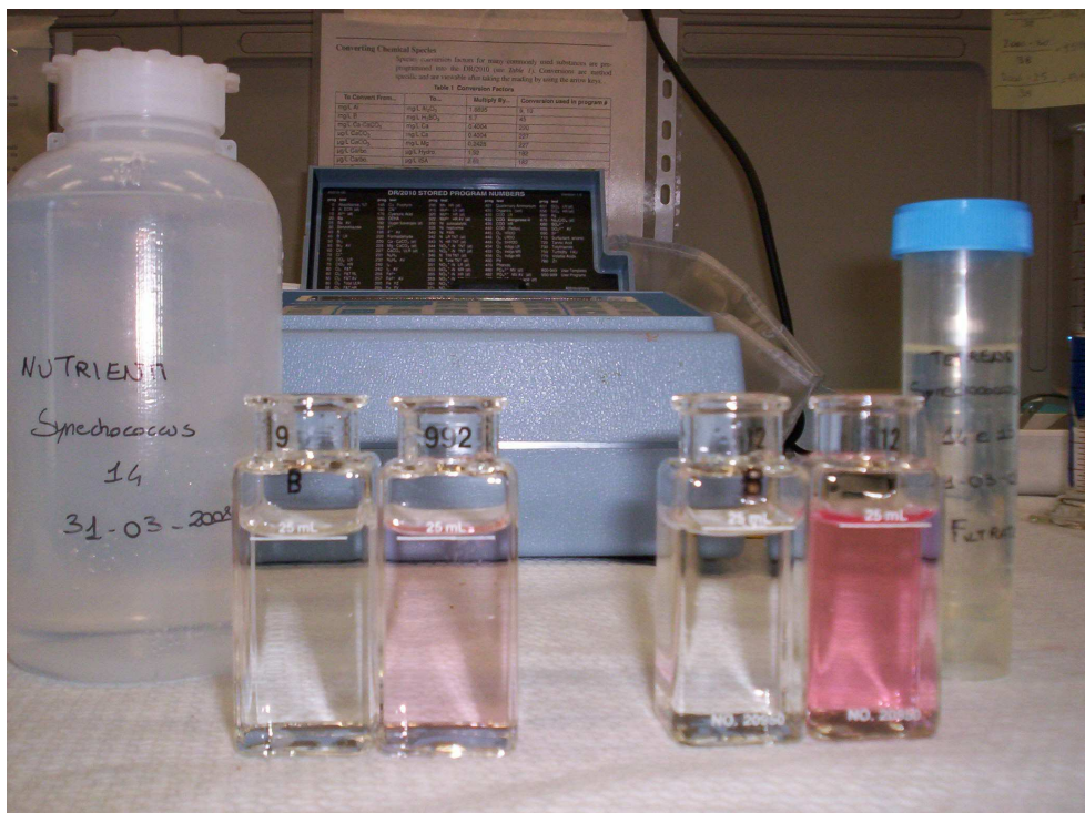
Fig. 2.6 Analisi dei nutrienti in un campione di acqua di coltura di Synechococcus elongatus (a sinistra), medesima analisi sul terreno della stessa coltura (a destra)
