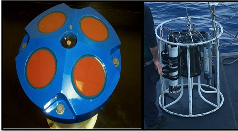
Figura 2.6: A sinistra l'ADCP, si noti le quattro teste arancioni che identificano il punto di emissione del segnale acustico. A destra la sonda CTD Idronauts montata nella rosetta.
